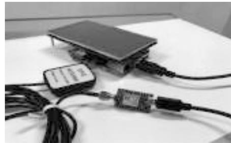
図13 Raspberry Piによるデータロガーの例
