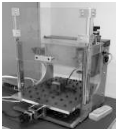
図7 組立てられた NC フライス盤
