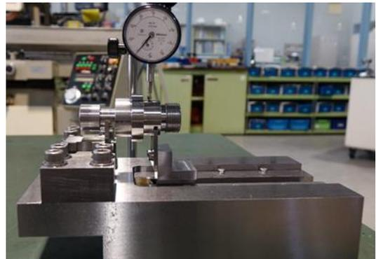
図 16 偏心測定器での計測の様子
