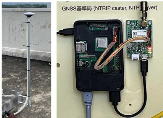
図 1 GNSS-RTK 用基準局
