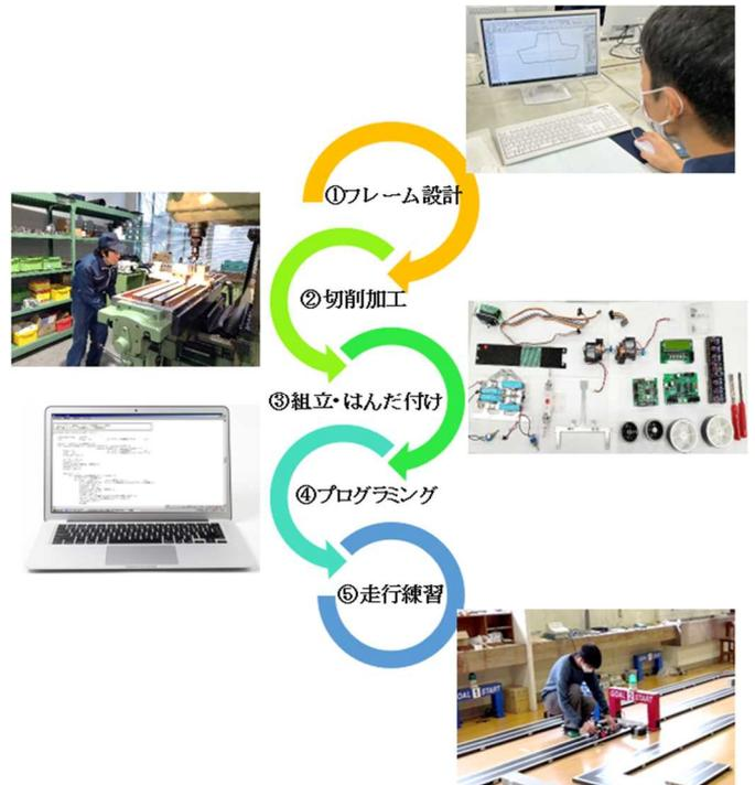
図8 マイコンカーの製作過程
