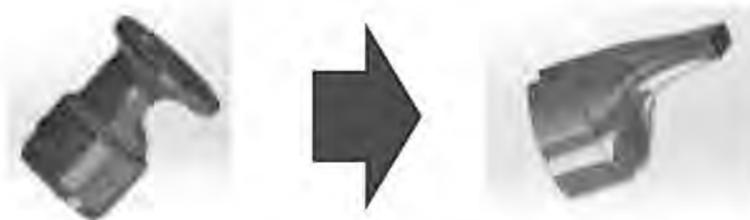
図9 唄口の改良(3DCAD図)
