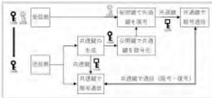
図1 ハイブリッド暗号方式による暗号通信
