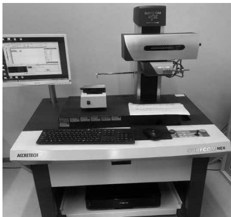
図 6 東京精密 サーフコム NEX 表面粗さ・輪郭形状測定機
