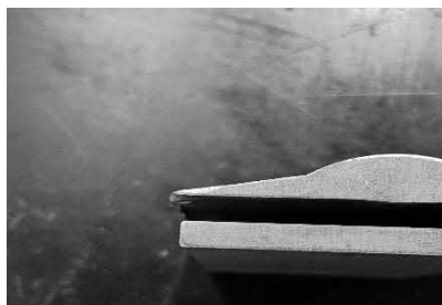
図15 曲がったパンチの状態
