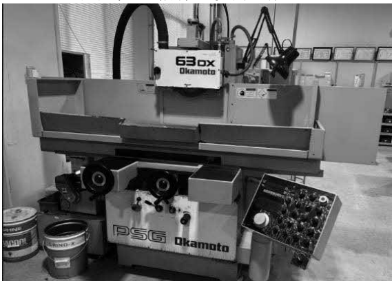
図 5 平面研削盤(岡本工作機械 PSG63DX)
